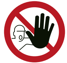
Abb. 5 Kennzeichnung D-P006 „Zutritt für Unbefugte Verboten“
