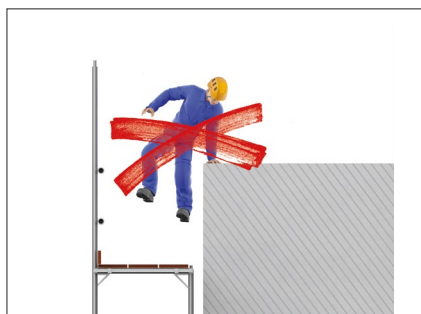
Auf Gerüstbeläge nicht abspringen
